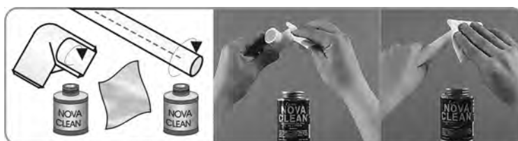
Рис. 26. Протирание очистителем Nova Clean соединяемых поверхностей
